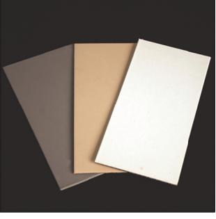
2. **Металл с покрытием ПВХ Sure-Flex:** оцинкованный стальной лист толщиной 0.7 мм покрытый слоем из неармированного ПВХ толщиной 1 мм. Лист используется для изготовления отливов и других профилированных деталей периметра. Мембрана ПВХ Sure-Flex сваривается горячим воздухом со слоем ПВХ. Металл ПВХ поставляется в листах размером 1.22 м x 3.05 м по 10 листов в упаковке. Цвет – белый, серый, бежевый.
