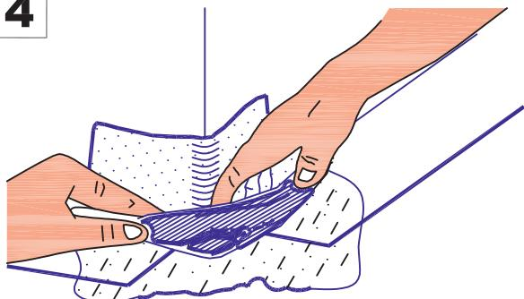
РАСТЯНІТЕ И РАСКАТАЙТЕ ВТОРУЮ ЧАСТЬ ЗАГОТОВКИ. ПЛОТНО ПРИЖМИТЕ В УГОЛОВМ ПЕРЕХОДЕ И ПРИЖМИТЕ К ГОРИЗОНТАЛЬНОЙ ПОВЕРХНОСТИ.
