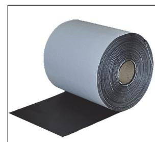
5. **Фартук Sure-Seal/Sure/White для обработки коробов:** фартук шириной 0.5 м и длиной 15.24 м, состоящий из вулканизированной мембранны EPDM толщиной 1.52 мм с заводской шовной лентой шириной 12.7 см по одной стороне. Фартук применяется для обработки коробов, фундаментов световых фонарей и др.
